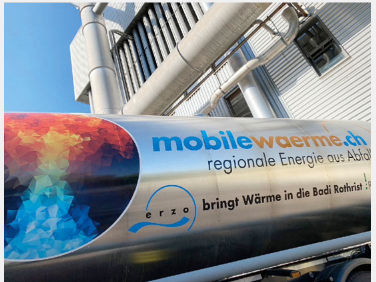
Fig. 1 Container mit dem Salz als Latentwärmespeicher.
